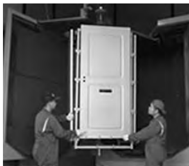
工場で改修するので焼付け塗装が可能に
