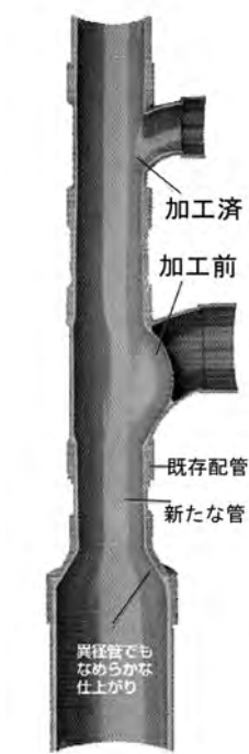
異径管もなめらかな仕上がり
